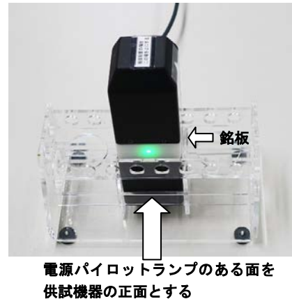
写真 1 電源ポート伝導妨害波測定時の供試機器 水平/垂直どちらの基準金属面でもこのように置く
