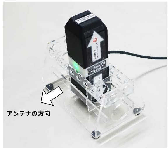
写真 3 垂直偏波測定時の供試機器の配置
